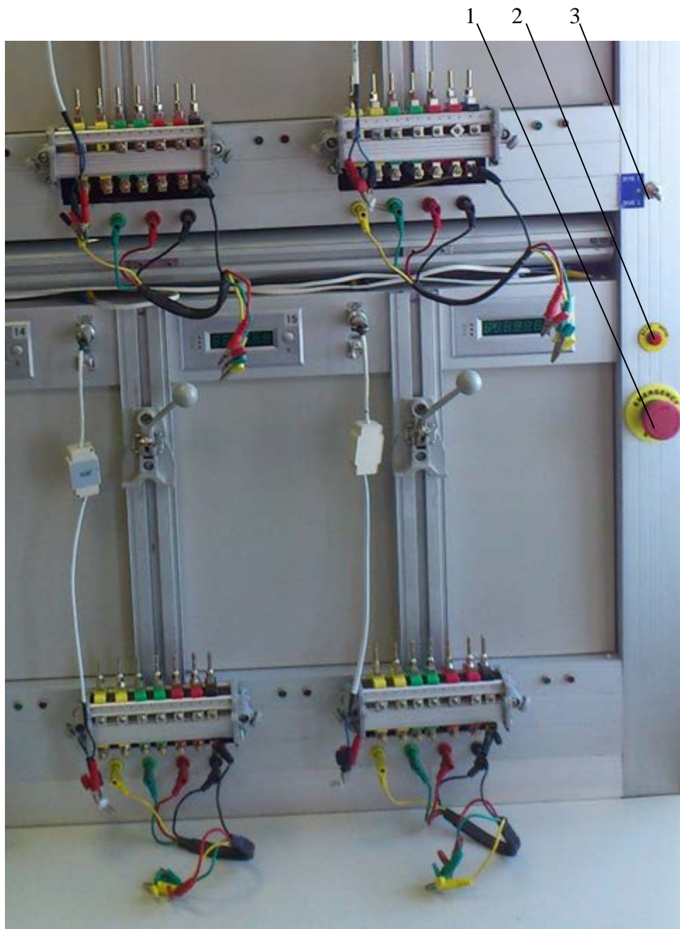
1 – кнопка аварийного отключения Установки от цепи питания « EMERGENCY STOP »; 2 – кнопка поднятия/опускания фотосчитывающих головок для установки/снятия поверяемых счетчиков « skan move »; 3 – переключатель реле. Рисунок 3.2.3 Лицевая панель Установки с выключателем аварийного отключения питания
